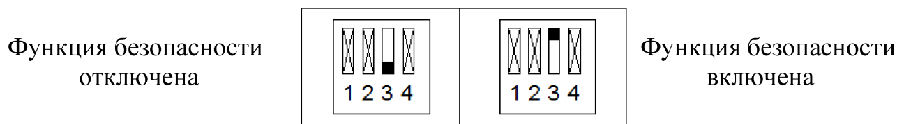
Рисунок 8. Комбинации положения переключателя SA1.3 для отключения функции безопасности
