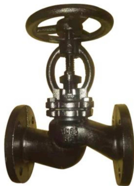
КЛАПАН ЗАПОРНЫЙ ЧУГУН 15КЧ16НЖ РУ25
