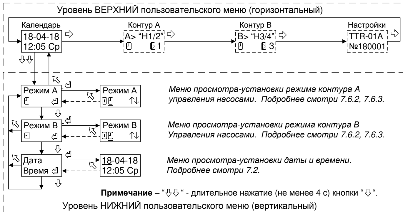
Рисунок 9 - Структура меню настройки режима работы контура
