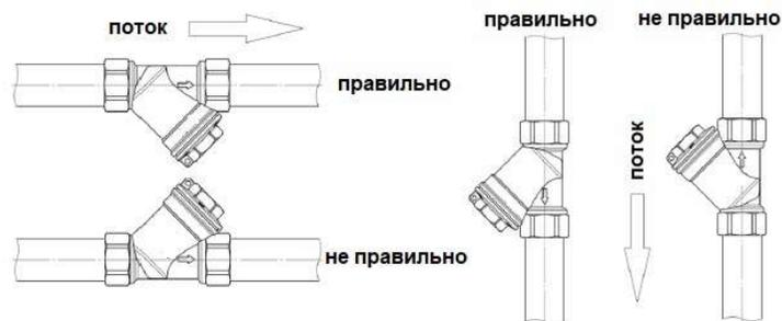
В соответствии с ГОСТ 12.2.063-2015 п.9.6, арматура не должна испытывать нагрузок от трубопровода (при изгибе, сжатии, растяжении, кручении, перекосах, вибрации, неравномерности затяжки крепежа и т.д.). При необходимости должны быть предусмотрены опоры или компенсаторы, устраняющие нагрузку на арматуру от трубопровода.
