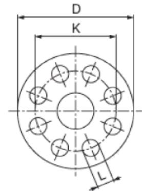
Гладкие проушины на затворе служат только для соблюдения соосности монтажа затвора с ответными фланцами. Пропустить болты (шпильки) только через две диагональные гладкие проушины, расположенные ближе к штоку, а двумя остальными стянуть фланцы рядом с корпусом (см. рисунок ниже). Данный тип монтажа не влияет на работоспособность и герметичность затвора.
